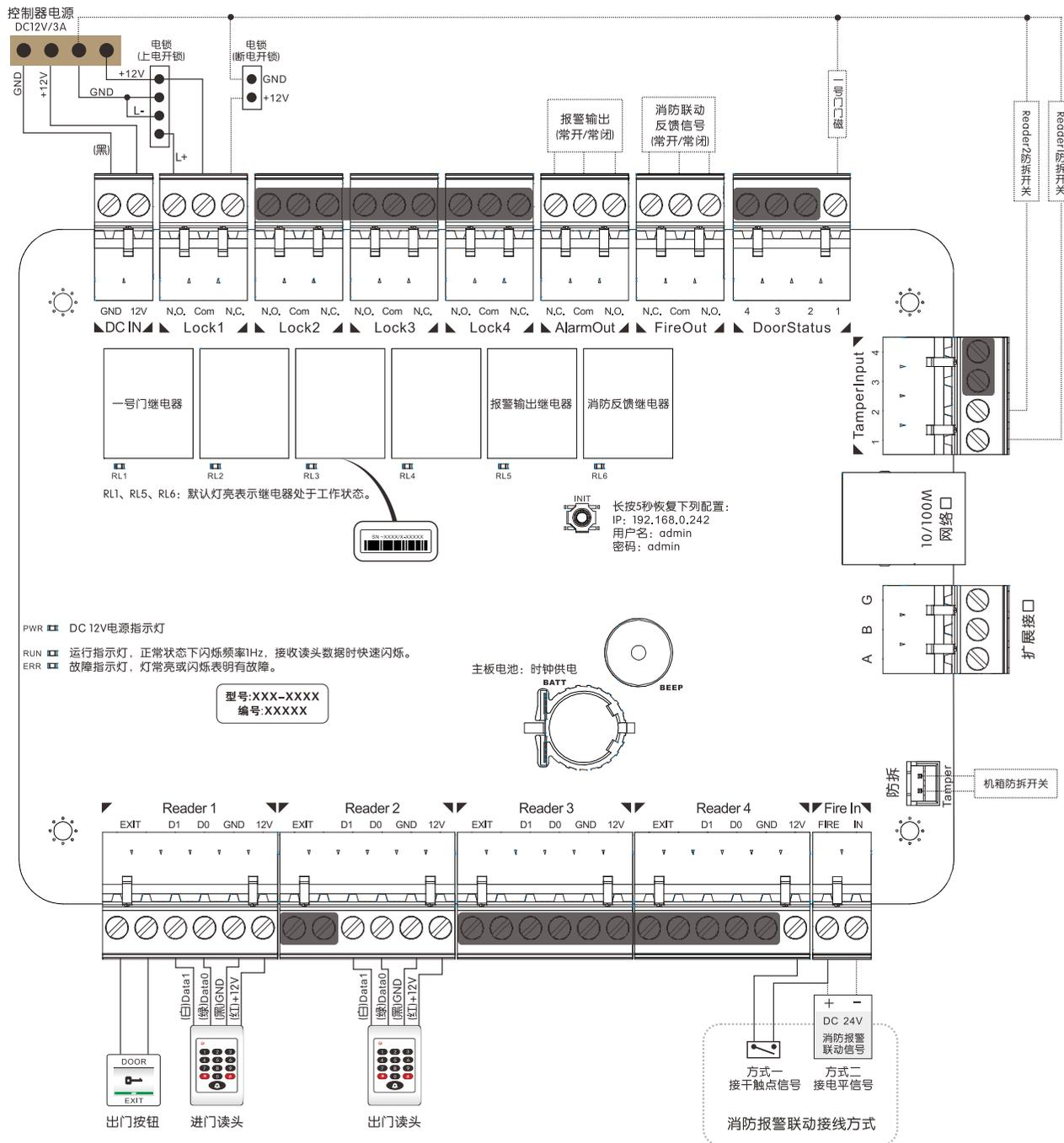
注: (1)上电开锁型电锁: 电控锁、灵性锁等。断电开锁型电锁: 电插锁、磁力锁等。
